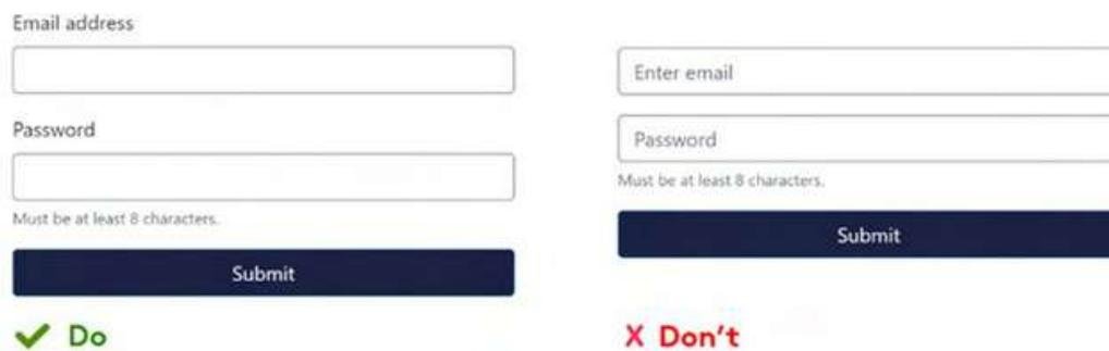
Figura 20: A la derecha, un mal ejemplo que muestra una descripción que desaparece cuando el usuario empieza a rellenar el formulario. A la izquierda se muestra un buen ejemplo de etiquetas que permanecen ahí también mientras el usuario rellena el formulario.
